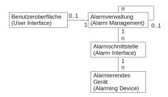
Die zentrale Einheit von Alarming ist die Alarmverwaltung. Diese kann hierarchisch aufgebaut und auf verschiedene Knoten verteilt sein. An einer Alarmverwaltung kann eine Benutzeroberfläche angebunden sein. Die alarmierenden Geräte sind über Alarmschnittstellen an die Alarmverwaltung angeschlossen.
